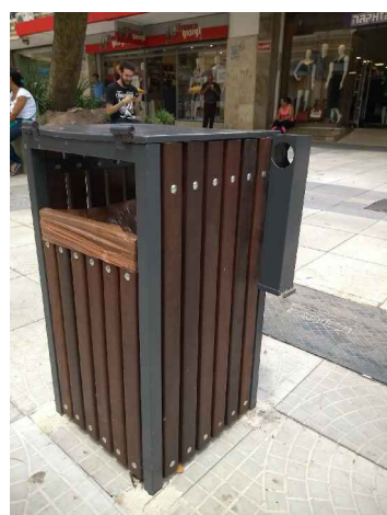
Estrutura em tubos e chapas de aço galvanizado Pintura epóxi Revestimento em madeira tratada com hidrofugante Altura 0,80m Cor: cinza grafite
